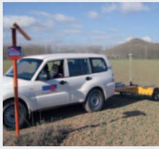
Georradars para inspeccionar el oleoducto
