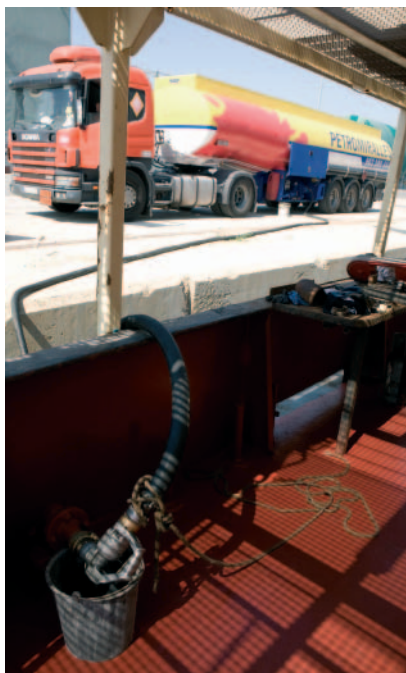
arriba: El servicio de búnker también se presta por medio de camiones cisterna acondicionados para suministrar combustibles marinos.
