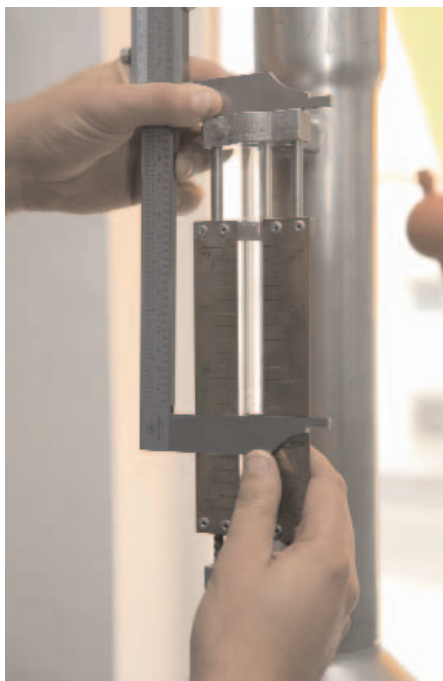
abajo: Detalle de algunos de los instrumentos utilizados en la calibración de vasijas con agua.
