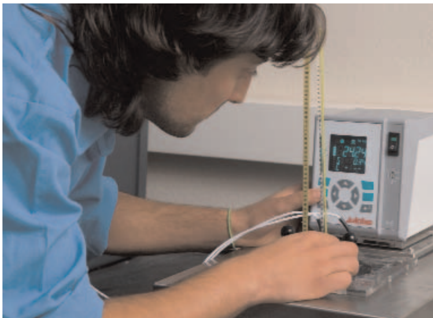
arriba: Calibración de termómetros en el laboratorio de temperatura.
