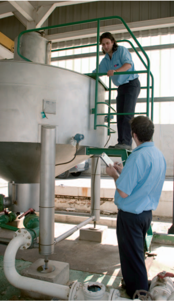
arriba: Uno de los dos patrones de medida con capacidad para 5.000 litros que se encuentran en las instalaciones de Loeches.
